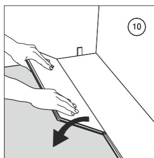
Установите первую доску следующего ряда (**рис. 10**) под небольшим углом к доске предыдущего ряда и уложите её на пол. Если между соединяемыми досками имеется некоторый зазор, убедитесь, что паз доски предыдущего ряда чистый.
