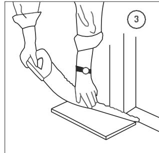
Компенсационный шов нужно оставлять также и у дверных порогов. Для этого можно отпилить часть нижней кромки порога либо установить подходящие пороговые или кромочные планки.
