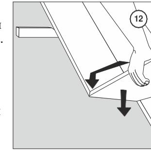
Вставьте монтажный клин (**рис. 11**) под уложенный последним паркетный элемент на расстоянии примерно 50 мм от его торца.
