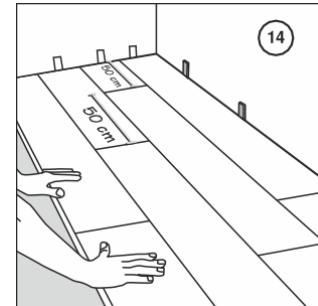
Компенсационный шов нужен в тех случаях, когда ширина помещения больше 12 м, а также между комнатами различной формы и отдельными помещениями. Компенсационный шов делают в дверном проеме, в углу или в другом подходящем месте и прикрывают отдельным плинтусом. При устройстве компенсационных швов следует соблюдать инструкции, относящиеся к расширительным зазорам.
