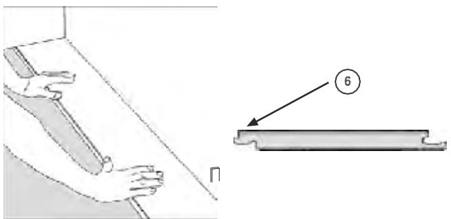
Начинайте укладку слева направо (**рис. 5**), от сплошной стены помещения, поместив первую доску продольным шипом к стене (**рис. 6**). Расстояние между досками и стеной можно отрегулировать с помощью клиньев позже, когда будут уложены три или четыре ряда.
